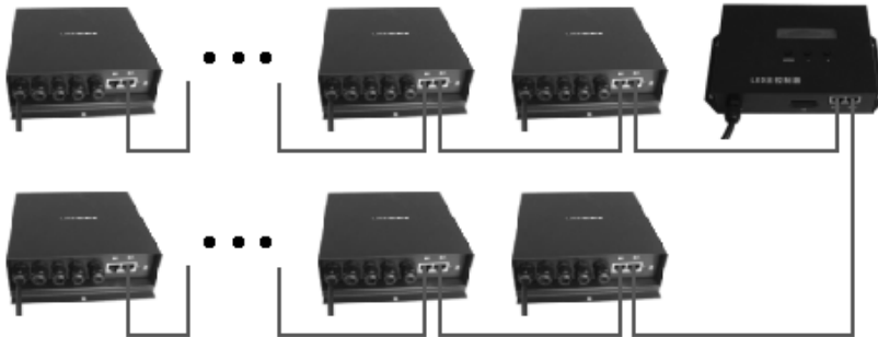
Рис 2. Slave-контроллеры подключаются к двум портам Master-контроллера.
