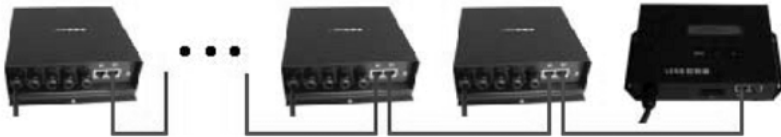
Рис 1. Все Slave-контроллеры подключаются к одному порту Master-контроллера.
